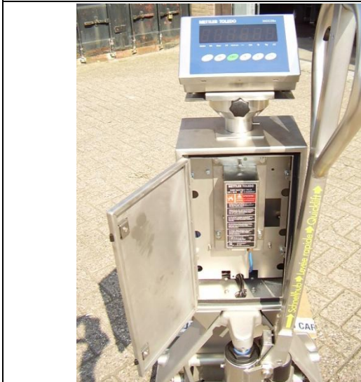
Demonteer de kabel door de connector linksom te draaien en vervolgens naar beneden te trekken
