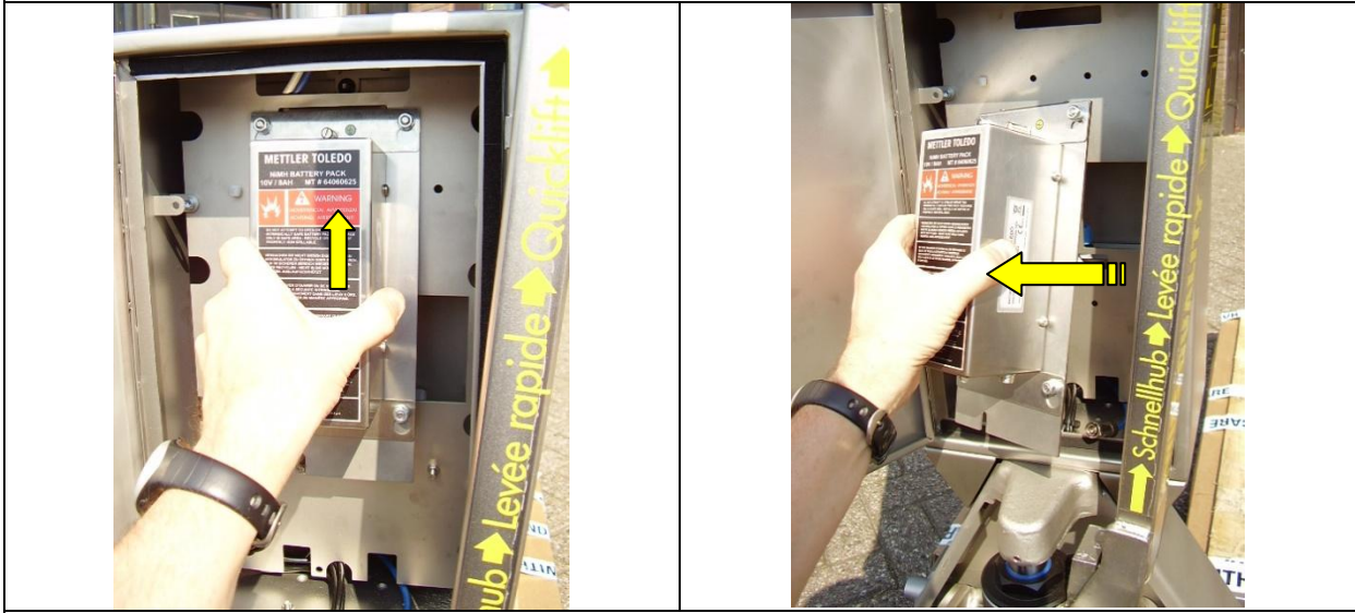
Batterie Modul leicht heben bevor herausnehmen
