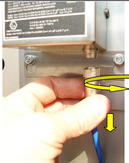
Demonteer de kabel door de connector linksom te draaien en vervolgens naar beneden te trekken
