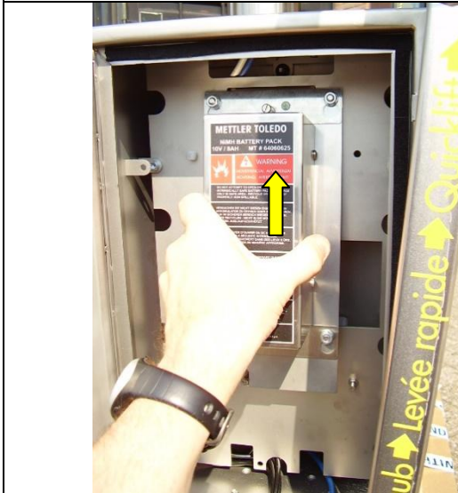
De batterij moduul lichtjes optillen voor het uitnemen
